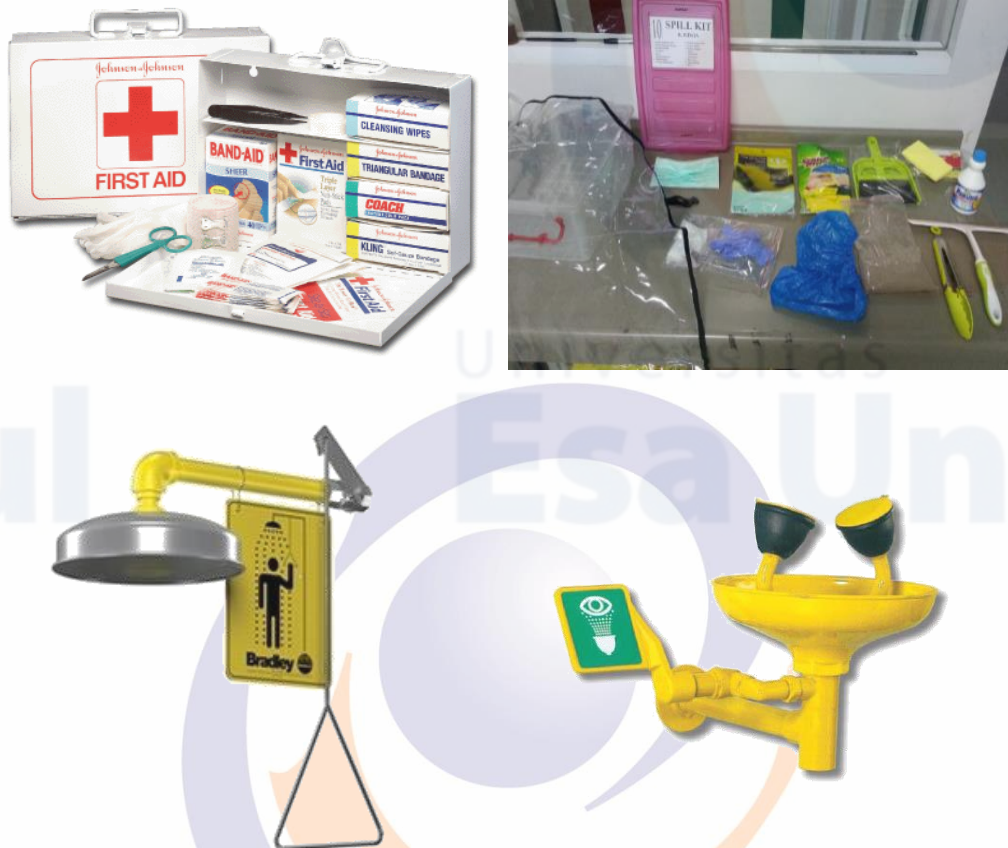
Gambar 7. Beberapa jenis kegawatdaruratan di laboratorium, kotak P3K (kiri atas), spill kit (kanan atas), emergency shower (kiri bawah) dan eye washer (kanan bawah).
