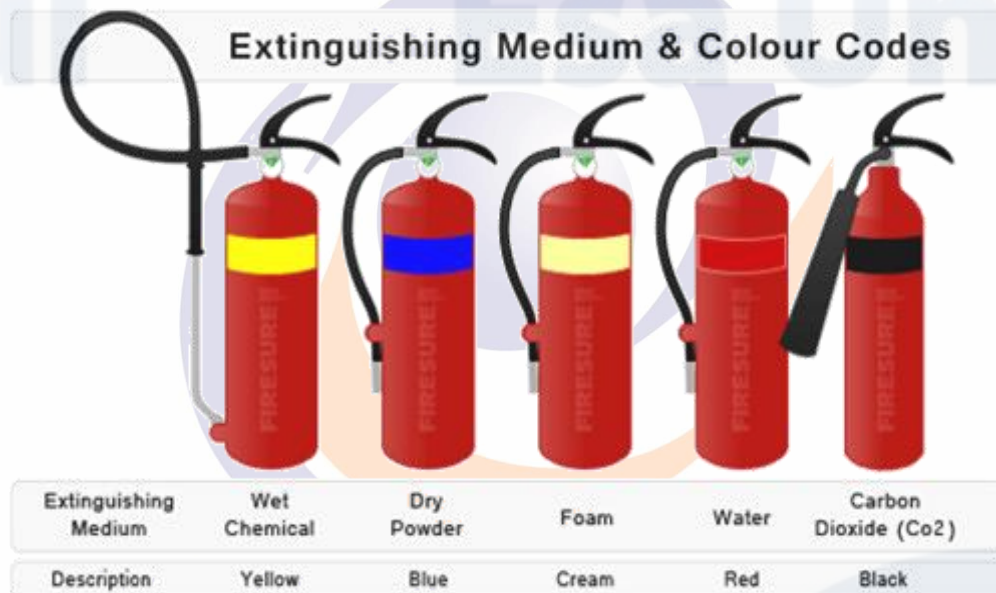
Gambar 4. Jenis-jenis pengkodean pada alat pemadam api ringan.
